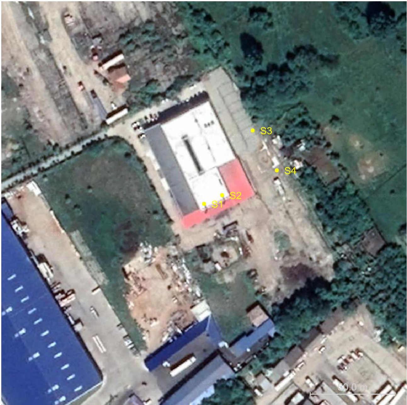
Figura 3 Surse fizice de poluanți identificate pe amplasamentul ROMBIS SRL. Originea sistemului de coordonate local utilizat în modelare (Stereo 70: 460084.88 E, 626563.99 N) coincide cu sursa S1. Coordonatele surselor sunt listate în Tabelul 2.
